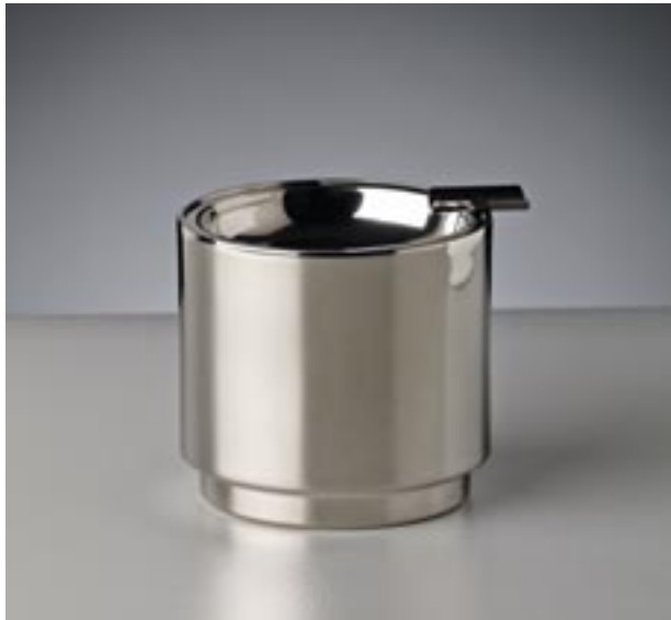
Marianne Brandt, 1924 Bereits 1924 entwarf Marianne Brandt einen zylindrischen Aschen- becher mit einem kippbaren Deckel, der die Asche in den darunterlie- genden Behälter rutschen lässt. Gleichzeitig dient der Deckel als Geruchsverschluss. Seitdem wurde dieses einfache Prinzip bei vielen später entstandenen Aschern nachgeahmt. As early as 1924 Marianne Brandt designed a cylindrical ashtray with a lid to be tilted, which enabled the ashes to drop into the container below, and served at the same time to seal off the smoke fumes. Since then, this simple principle has been copied by many designers. Edelstahl poliert Polished stainless steel
